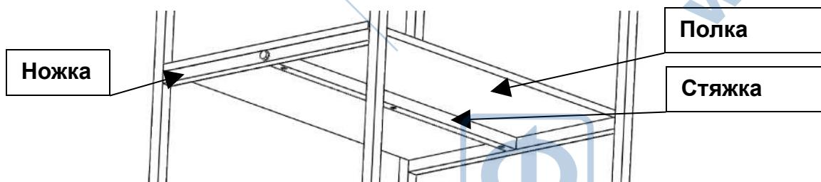
3. Присоединить при помощи болтов M8x25, гаек M8 и шайб 8 ножки к коробу.
