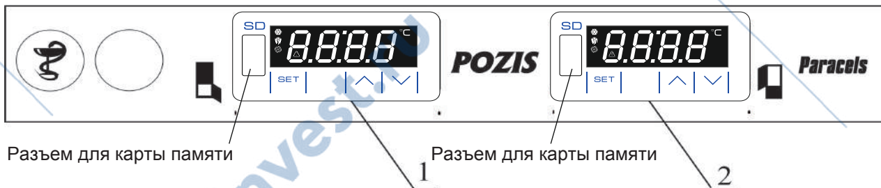
Рис.2 Схема расположения приборов управления 1 – контроллер морозильной камеры; 2 – контроллер холодильной камеры
