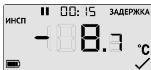
Рис. 30. Инспектирование. Устройство во временной паузе
