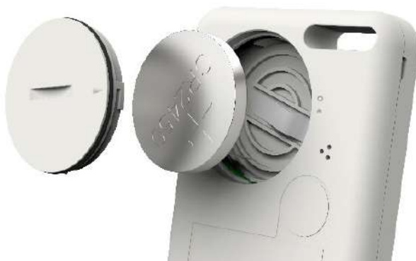
Рис. 36. Замена источника питания
