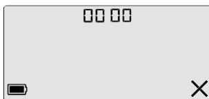
Рис. 4. Отсутствуют заводские настройки
