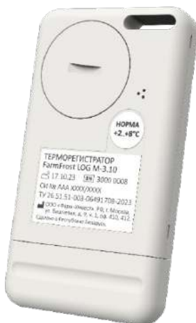
Рис. 23. Маркировка Устройства стикером «НОРМА»
