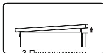
3. Приподнимите верхнюю крышку спереди и установите упор.
