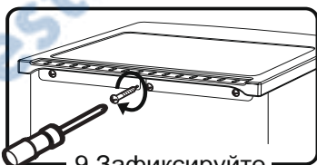
9. Зафиксируйте верхнюю крышку сзади.
