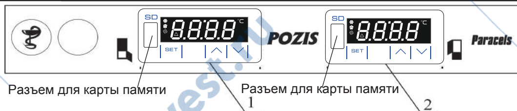
Рис.2 Схема расположения приборов управления
