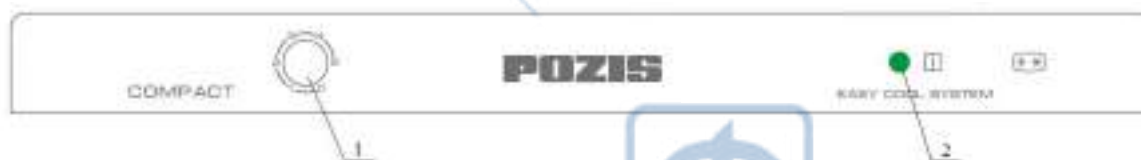
Рис.2 Регулировка температурного режима 1 – ручка терморегулятора; 2 – индикаторная лампа (сеть) ;
