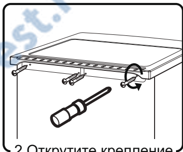
2. Открутите крепление верхней крышки с задней стороны прибора.
