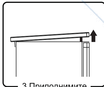
3. Приподнимите верхнюю крышку спереди и установите упор.
